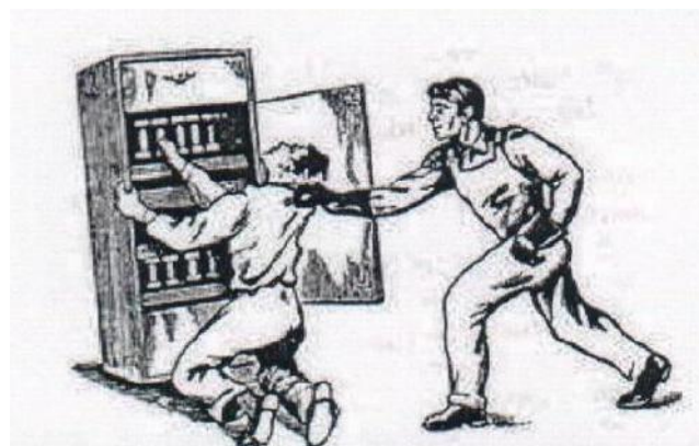
Рис. 4. Освобождение пострадавшего от токоведущей части электрического тока
